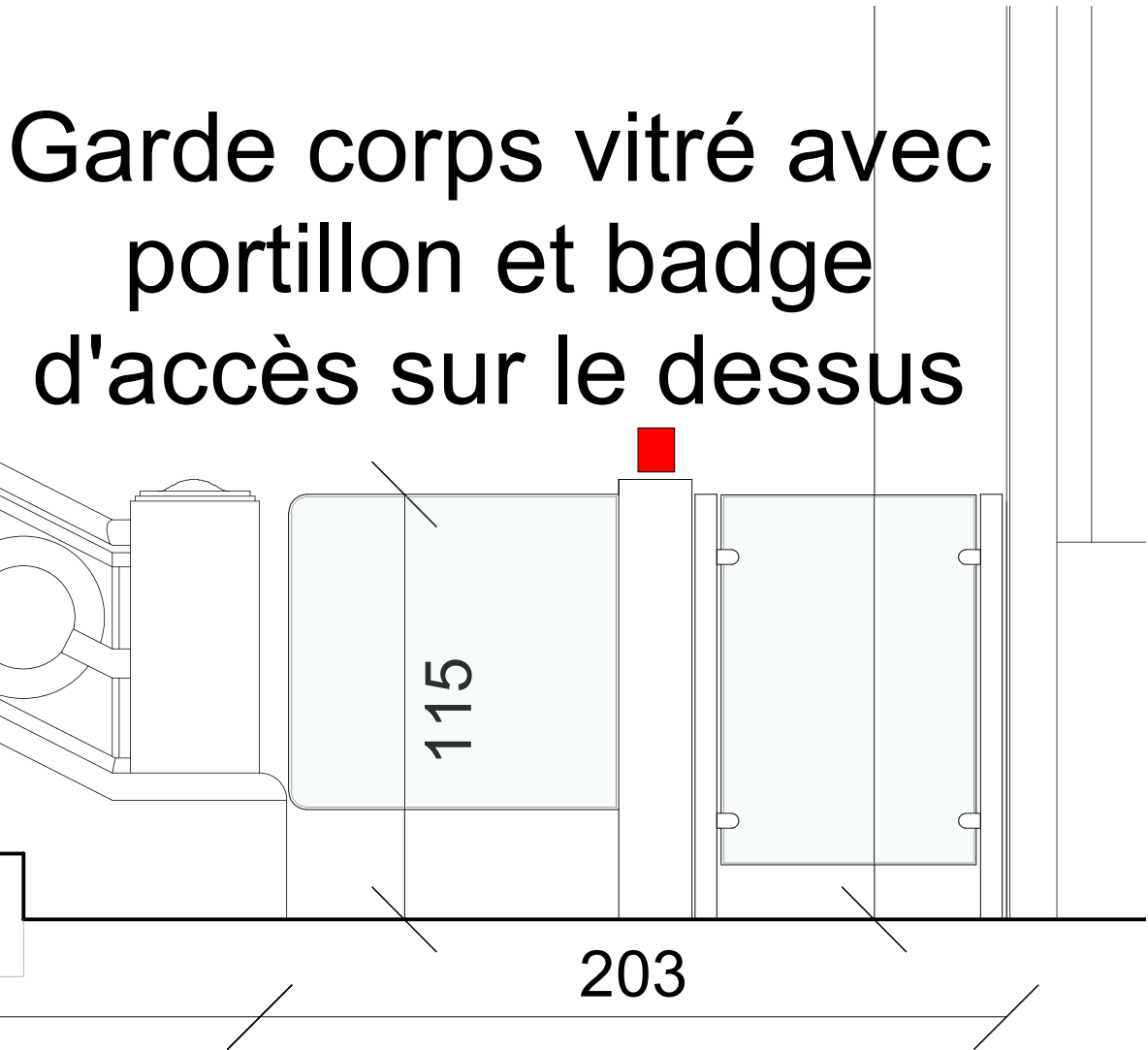
ÉLÉVATION : PORTILLON ET GARDE-CORPS VITRÉ Vitrages non blindés
